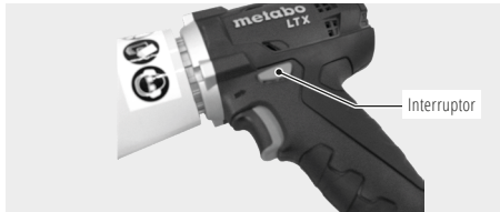
Variante de batería (RPG 3.0): Colocar el interruptor en la posición central para bloquear el interruptor de conexión/desconexión.
