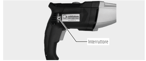
Variante elettrica (RPG 3.0): portare l'interruttore in posizione centrale per bloccare l'interruttore On/Off
